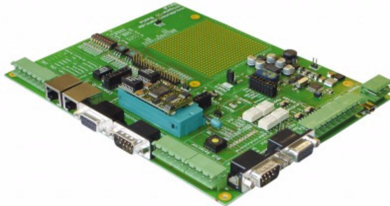
Das oder die benötigten UNIGATE® ICs werden separat bestellt. Die je nach Ausführung benötigte Spannung (5 Volt oder 3,3 Volt) ist einstellbar. Für die Anbindung an den PC (DEBUG-Schnittstelle) steht sowohl eine RS232-Schnittstelle wie auch ein USB-Anschluss zur Auswahl.
