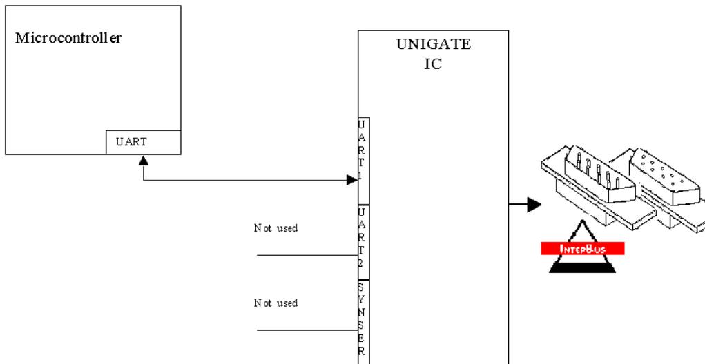
Das UNIGATE<sup>®</sup> IC wickelt selbständig die Kommunikation mit dem Kundengerät über die TTL-Schnittstelle ab.
