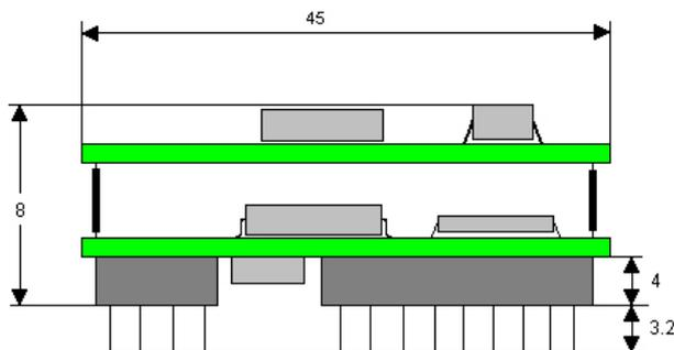
Die Stifte des UNIGATE<sup>®</sup> IC - Interbus sind im Rastermaß 2,54 mm angeordnet.
