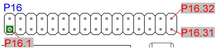
Hier sind alle 32 digitalen Ausgänge der Schieberegister verfügbar. Zusätzlich sind die LED's D9, D15..D18, D20 an den Schieberegistern angeschlossen.
