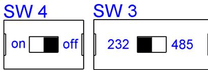
Diese Schalter sind für die Einstellung der seriellen Schnittstelle nötig. Mit dem Schalter SW3 kann zwischen einer RS232- und einer RS485-Schnittstelle umgeschaltet werden. Dies ist die Schnittstelle, an der das Kundengerät angeschlossen ist. Die Debug-Schnittstelle ist immer mit RS232-Pegeln herausgeführt.
