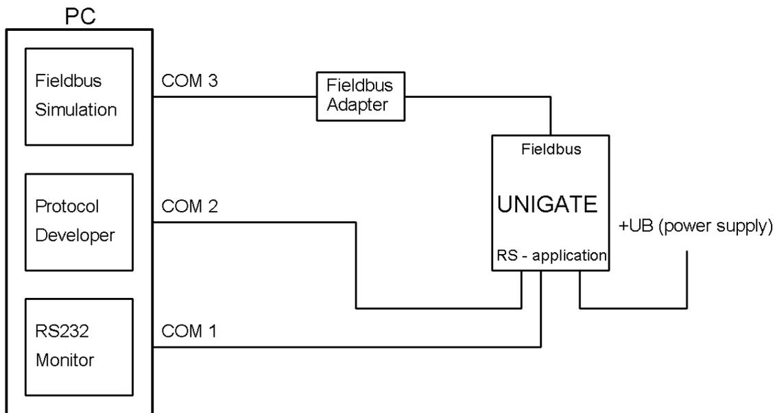
Für einen transparenten Datenaustausch können Sie sich das im Protocol Developer hinterlegte File laden (File -> New -> „Interbus\_IC\_Basisboard.dss“).
