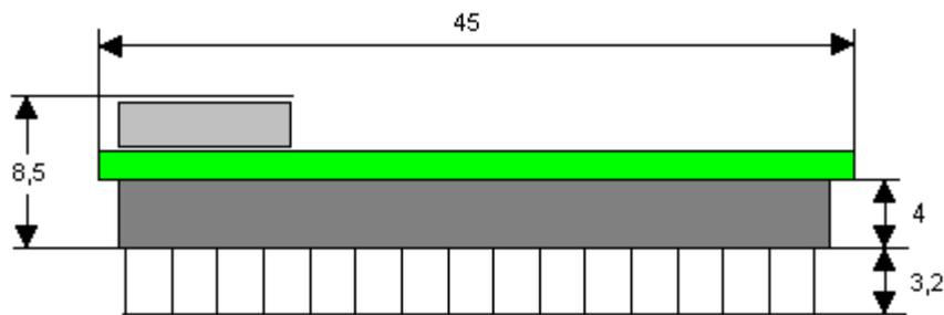
Die Stifte des UNIGATE<sup>®</sup> IC - Interbus sind im Rastermaß 2,54 mm angeordnet.
