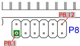
In der Abbildung finden Sie die Anordnung der Pins. Auf dieser Steckbrückenleiste sind die Signale der seriellen Verbindung zwischen IC und RS-Treibern aufgelegt. Für eine initiale Entwicklung werden Sie wahrscheinlich auch in Ihrer Applikation einen vorhandenen Treiber nutzen. Um diesen später auszutauschen, können Sie die Signale der seriellen Schnittstelle auch direkt hier abgreifen.
