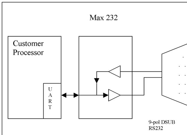
Ihr Gerät, das im wesentlichen wie oben aufgebaut sein dürfte wird nun modifiziert, so dass an der 9-pol Buchse der Interbus<sup>1</sup> zur Verfügung steht. Um die Belegung normgerecht zu halten, ist allerdings ein Hardware-Redesign nötig.
