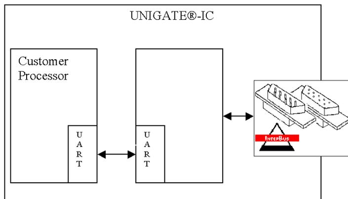
Nach dem Austausch des RS232 Treibers durch das UNIGATE® IC steht an der 9-pol D-SUB-Buchse der Interbus<sup>1</sup> zur Verfügung.
