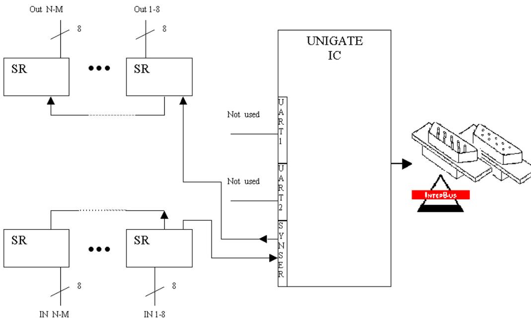
Hier wird lediglich die synchrone serielle Schnittstelle benutzt, die asynchrone serielle Schnittstelle ist hier im Prinzip ohne Bedeutung. Falls sie das Script jedoch in Ihrer fertigen Anwendung programmieren möchten, empfiehlt sich der Einsatz einer Pfostenleiste für die asynchrone Schnittstelle, Sie können damit die ISP Programmierung vornehmen.
