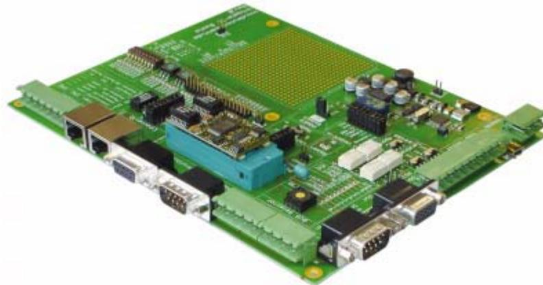
Das oder die benötigten UNIGATE<sup>®</sup> ICs werden separat bestellt. Die je nach Ausführung benötigte Spannung (5 Volt oder 3,3 Volt) ist einstellbar. Für die Anbindung an den PC (DEBUG-Schnittstelle) steht sowohl eine RS232-Schnittstelle wie auch ein USB-Anschluß zur Auswahl.
