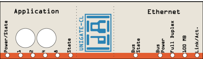
Bild 2: Frontblende: Drehschalter und Leuchtanzeigen
