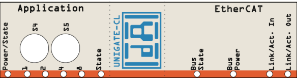
Bild 2: Frontblende: Drehschalter und Leuchtanzeigen
