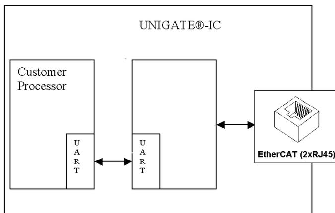
Nach dem Austausch des RS232 Treibers durch das UNIGATE® IC2 steht an den RJ45-Buchsen EtherCAT® zur Verfügung.
