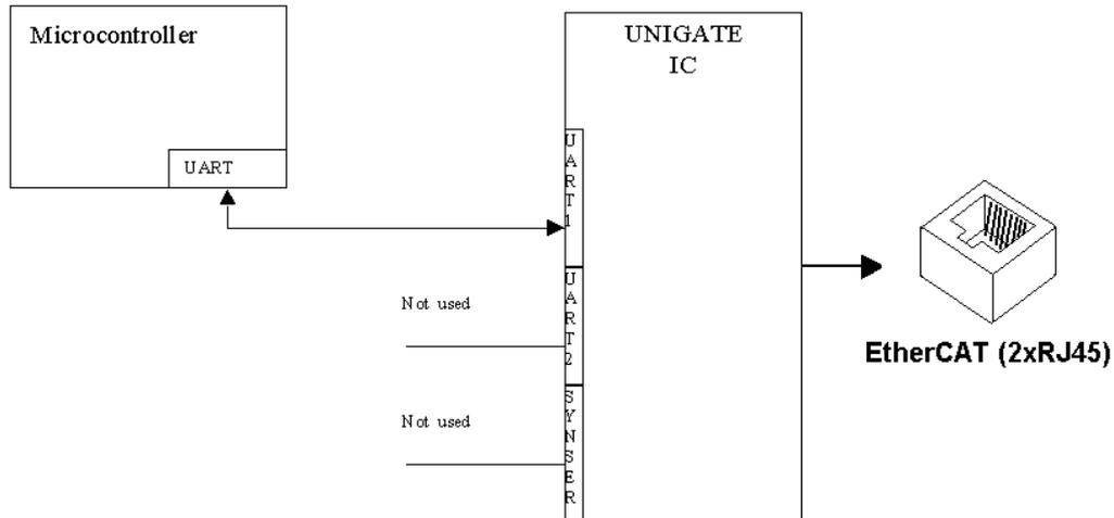
Das UNIGATE<sup>®</sup> IC2 wickelt selbständig die Kommunikation mit dem Kundengerät über die TTL-Schnittstelle ab.
