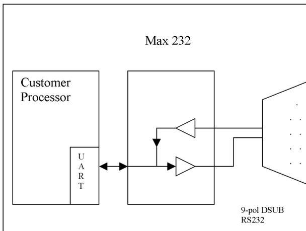
Ihr Gerät, das im wesentlichen wie oben aufgebaut sein dürfte wird nun modifiziert, so dass an der 9-pol Buchse der EtherCAT® zur Verfügung steht. Um die Belegung normgerecht zu halten, ist allerdings ein Hardware-Redesign nötig.
