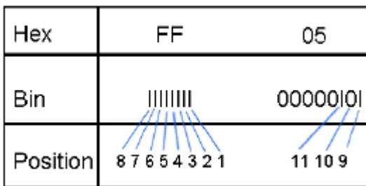
Bitte beachten sie das No. Of coils = 10 ist, deswegen wird bei dem Wert 0x05 nur das untere Bit in Adresse 0011 geschrieben, Adress 0013 wäre schon das Bit Nr 11 das nicht mehr übertragen wird.
