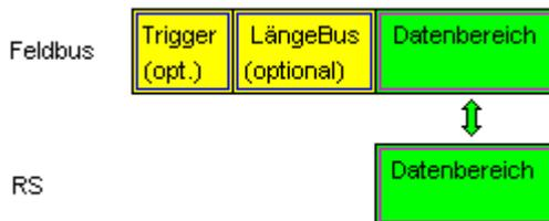
Auf der RS-Eingangsseite ist eine Timeoutzeit von 2 ms fest eingestellt. Werden innerhalb der Timeoutzeit keine weiteren Daten empfangen, werden die bis dahin empfangenen Daten auf den Bus übertragen.
